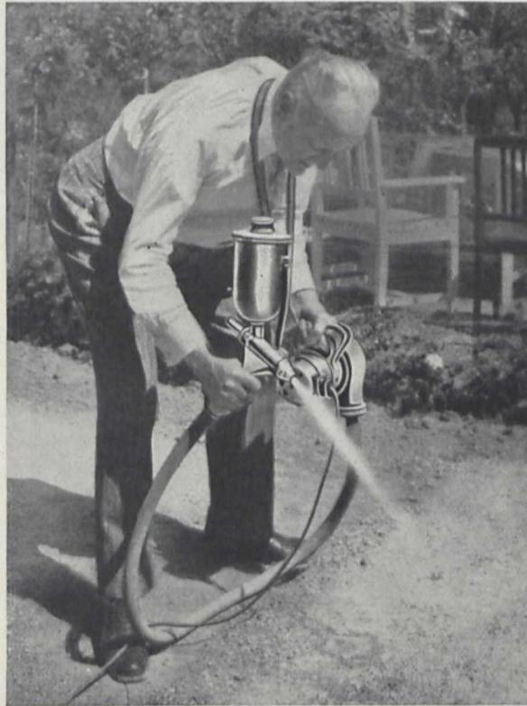
Fig. 1. Statt die Erde mit Pappstreifen zu belegen (Fig. 2), spritzt man mittels der Spritzpistole eine Papierhaut auf.
