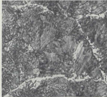
Fig. 2. Gefüge des gegossenen Blockes Stahl, aus dem Rasierklingen hergestellt werden. Die großen Zementitnetze werden durch Schmieden und Walzen verarbeitet, bis sie wie Fig. 1 aussehen. Vergr. 450fach.
