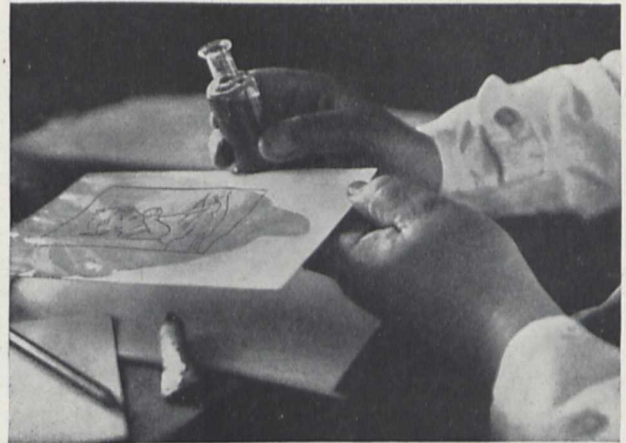
Fig. 2. Gleichmäßiges Uebergießen der Zeichnung mit Spirituslack.
