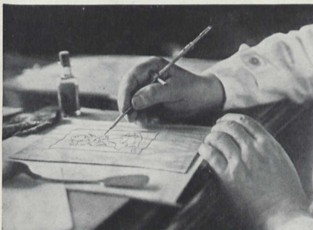
Fig. 3. Mit einer Nadel wird die Zeichnung durch die Lackschicht gekratzt.
