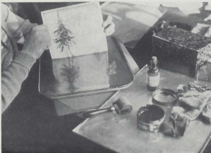
Fig. 3. Zeichnung mit Erosit -Tinte auf gut geleinem Papier, die „gedruckt“ werden soll.
