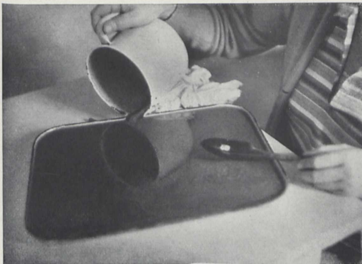
Fig. 2. Die dickflüssige Gelatine wird in eine Schale mit niedrigem Rand gegossen.
