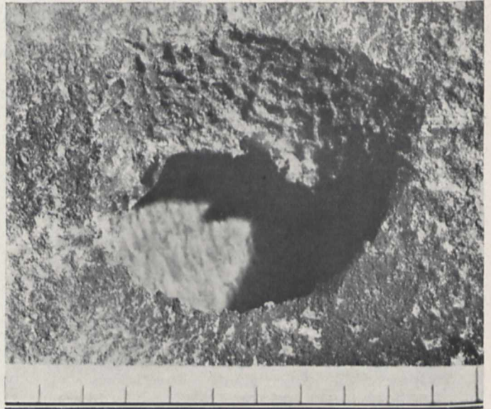
Fig. 3. Bohrloch der Riesenholzwespe, von der Innenseite gesehen. Die einzelnen Nagespuren sind deutlich sichtbar. Der Maßstab unten in Millimetern. (Etwa 10fach vergr.).
