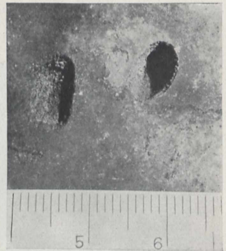
Fig. 2. Bohrlöcher der Riesenholzwespe auf der Innenseite einer Bleiplatte. Das linke Bohrloch ist nicht durch das Blei durchgedrungen. (Maßstab in Zentimetern).
