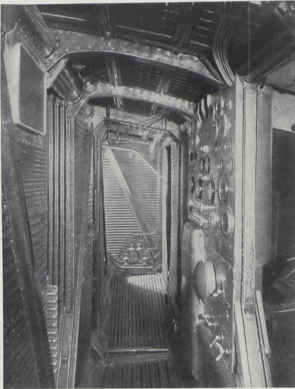
Fig. 4. Querschnitt durch den Flügel und Maschinenraum mit Schalttafel und Meßgeräten. An der rechten Seite die Eingänge zu den Backbordmotoren.
