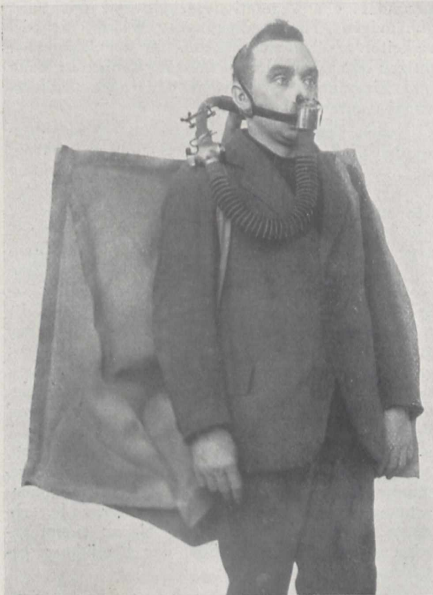
Fig. 2. Apparatur für Atmungsversuche am Menschen während der Arbeit.
