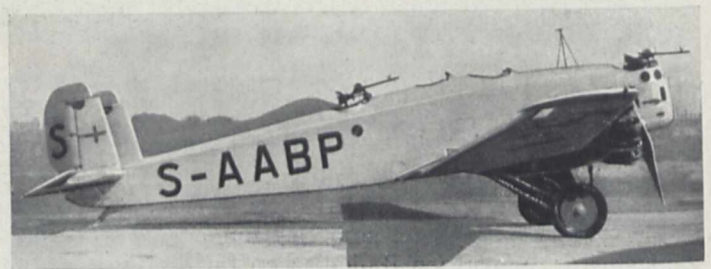
Fig. 5. Das neueste schwedische Bombenflugzeug K 37 der Flugindustrie in Limhamn. Die beiden Maschinengewehre in der Rumpfkabine können durch eine Maschinenkanone ersetzt werden.
