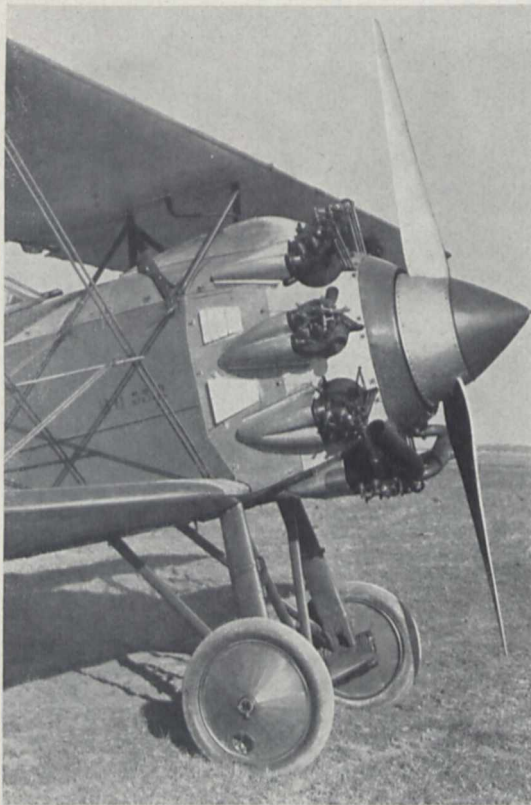
Fig. 4. Der windschnittige Einbau des 450-PS-Bristol-„Jupiter“-Motors im Rumpfbug des tschecho-slowakischen Avia-Kampfeinsitzers BH 33.
