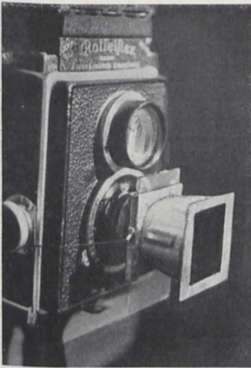
Fig. 5. Der Gegenlicht-Tubus mit Schlitz für Gelbscheibe.
