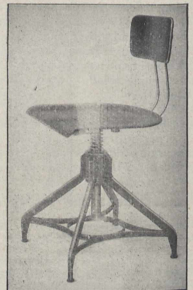
Fig. 6. Zweckmäßiger Arbeitsstuhl. Das Gestell ist aus gepreßtem Stahl, der Sitz drehbar und gegen Erschütterungen gefedert. Höhe von Sitz und Rückenlehne ist verstellbar. (Siemens-Schuckert-Elmo-Werk.) (Aus dem „Reichsarbeitsblatt“.)
