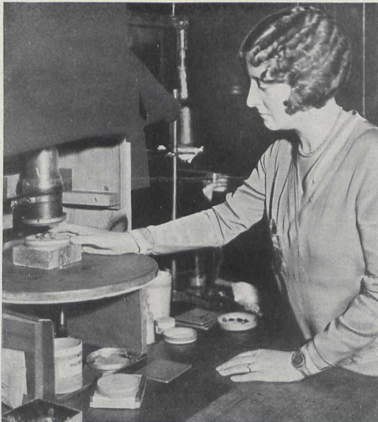
Fig. 2. Saphire werden durch Belichtung mit Kathodenstrahlen auf ihre Echtheit geprüft.
