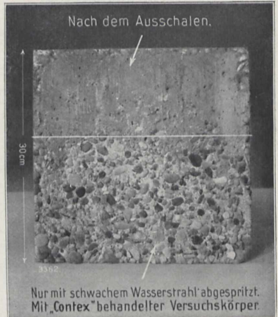
Fig. 2 (rechts). Mit Contex behandelte Versuchskörper. Oben nach dem Ausschalen, unten nach Abspritzen durch Wasser.
