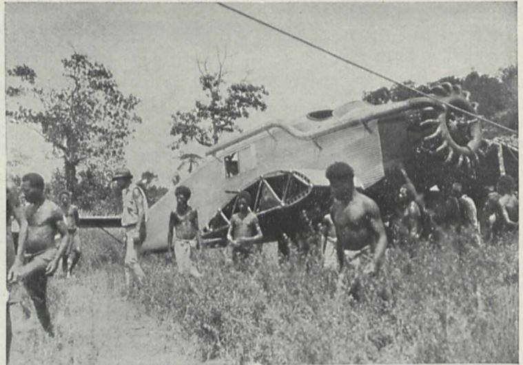
Fig. 5. Nach Unterbau des Fahrgestells wird das Flugzeug an Land gebracht, um die Tragflächen zu montieren.
