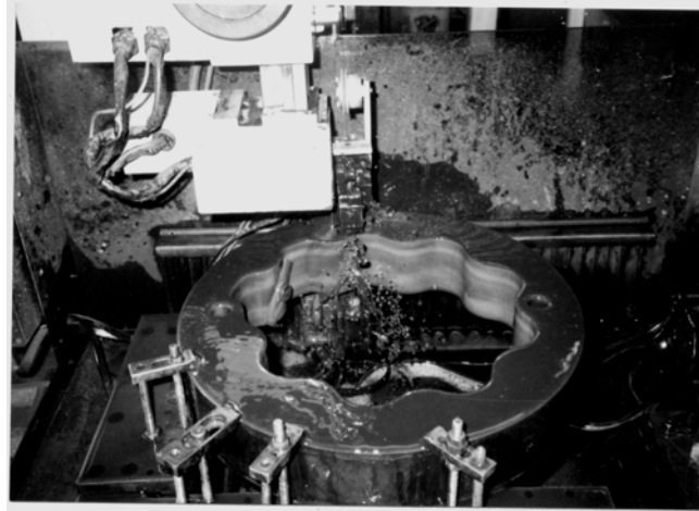
Rys. 8.31. Obróbka koła o uzębieniu wewnętrznym cykloidalnym 3. rodzaju prowadzona metodą wykrawania elektroerozyjnego
