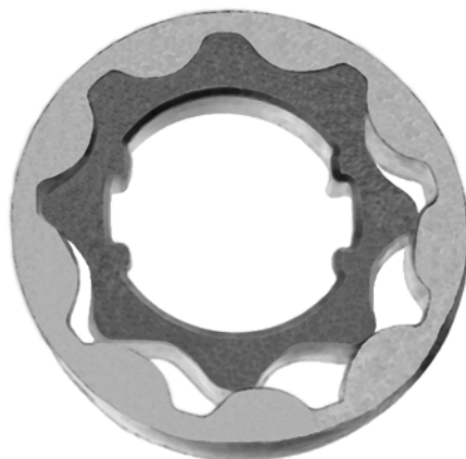
Rys. 8.36. Zespół kół o zazębieniu epicykloidalnym 3. rodzaju wykonanych metodą spiekania proszków
