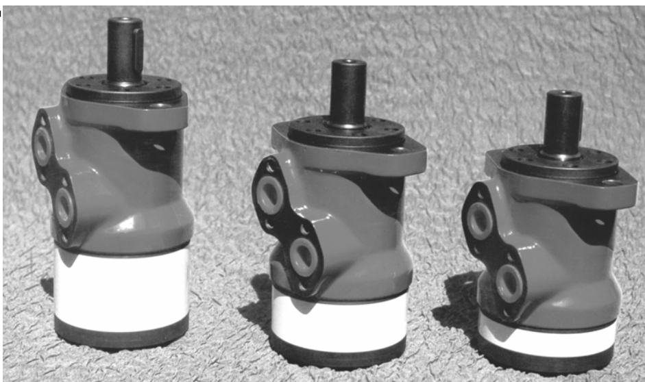
Rys. 10.26. Zespół kół cykloidalnych przeznaczony do silników orbitalnych: a) widok zespołu kół epicykloidalnych, stosowanego w silniku, b) widok silników orbitalnych o chłonnościach (od lewej) q = 315, 160, 80 \text{ cm}^3/\text{obr} .
