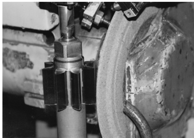
Rys. 8.6. Obróbka wykańczająca koła o uzębieniu ewolwentowym przez szlifowanie metodą Maaga
