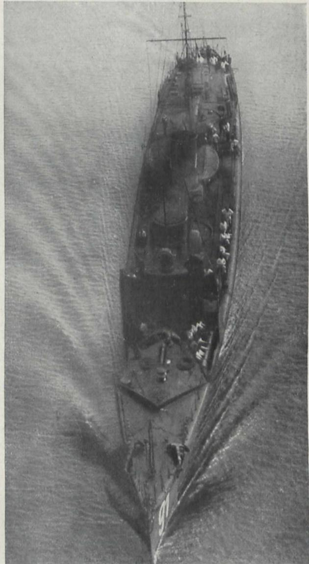
Fig. 7. Turbulente Wasserströmung, ausgehend von der Außenhaut eines fahrenden Schiffes.
