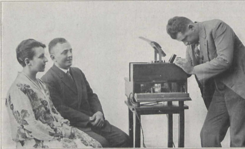
Fig. 5. Tageslichtfernsehsender der Telehor-Gesellschaft mit Vorverstärker. Eine Lupe gestattet die Beobachtung des Fernsehenders während der Aufnahme auf Größe und Schärfe. Der Apparat ist beweglich wie ein Kinoaufnahmeapparat.
