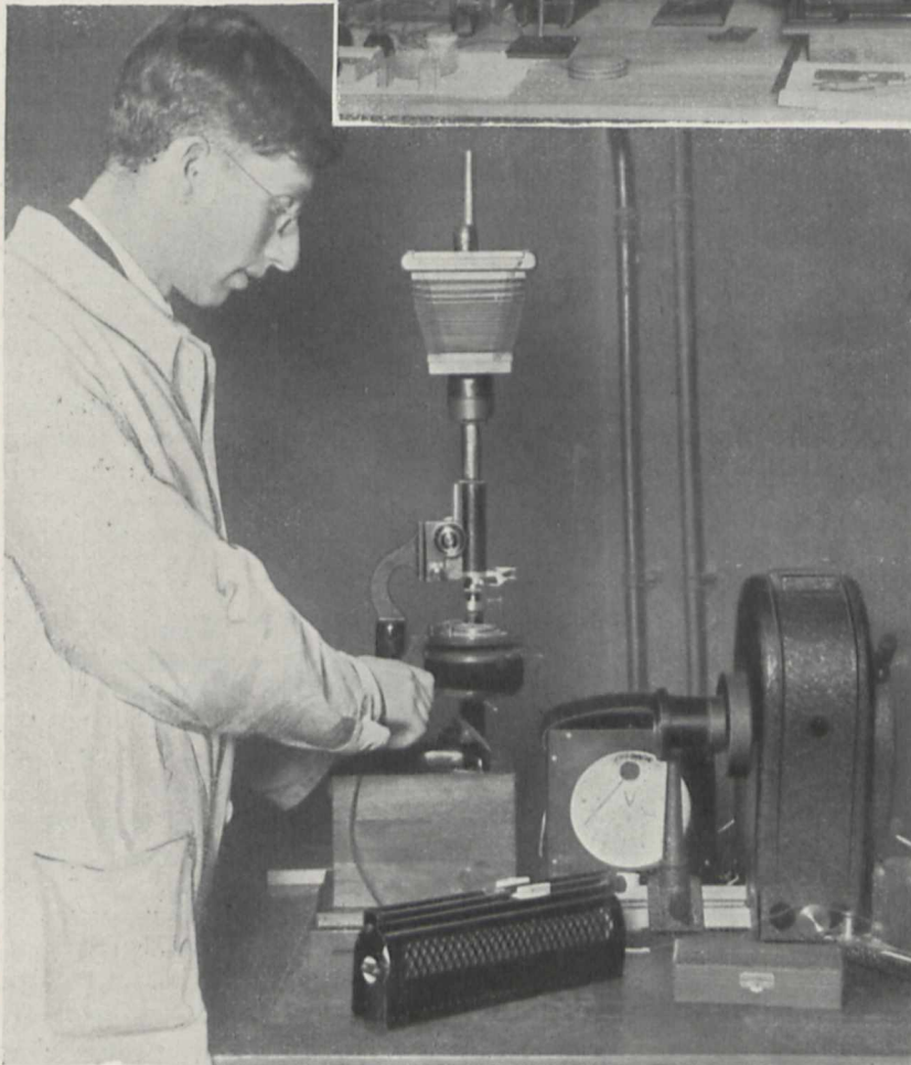
Fig. 2. Ultramikroskop zur Beobachtung und Photographie von geschmolzenen Salzen bei hohen Temperaturen (nach B. Lange).
