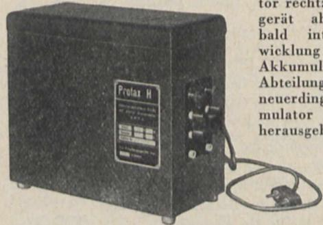
Trockengleichrichter und Umschalter zum Laden des Akkumulators.
