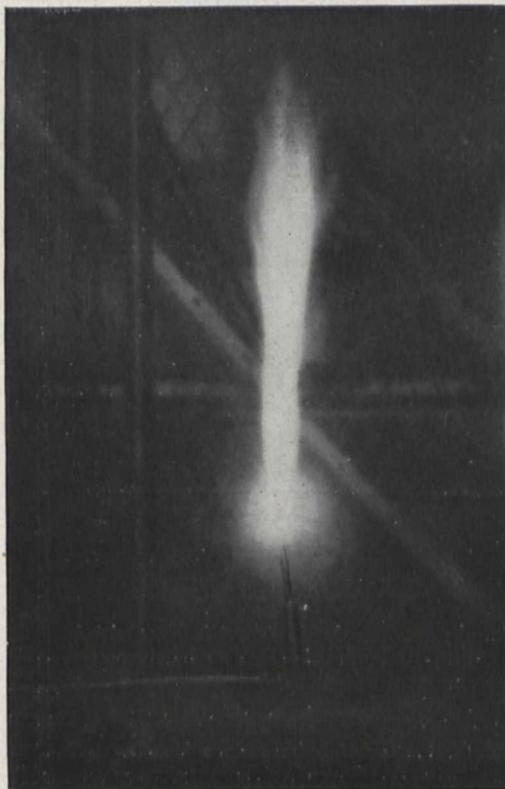
Fig. 3. Der künstliche Kugelblitz am Ende einer 3 m langen Sendeantenne.
