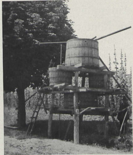
Fig. 3. Vorrichtung zur Herstellung der Kupferkalkbrühe.
