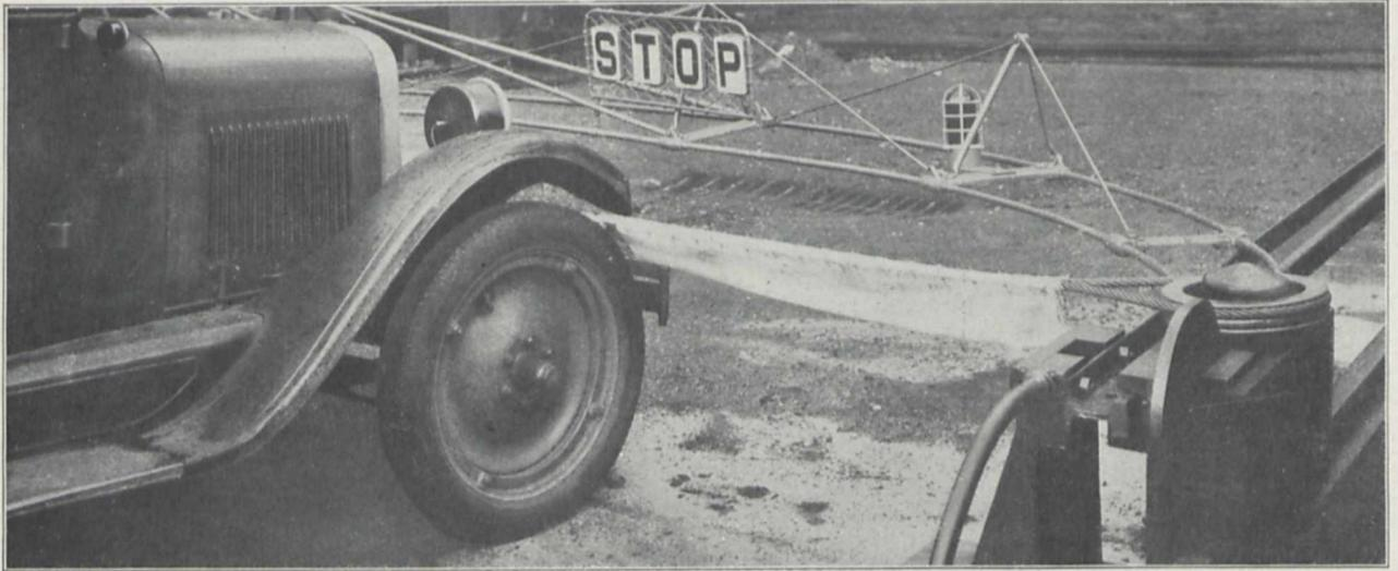
Fig. 1. Die Schranke ist geschlossen. Die Räder des Autos stehen dicht vor dem Kabel, welches in die Höhe federte, sodaß es zwischen den oberen Rand der Räder und die Unterseite der Kotflügel zu liegen kommt.
