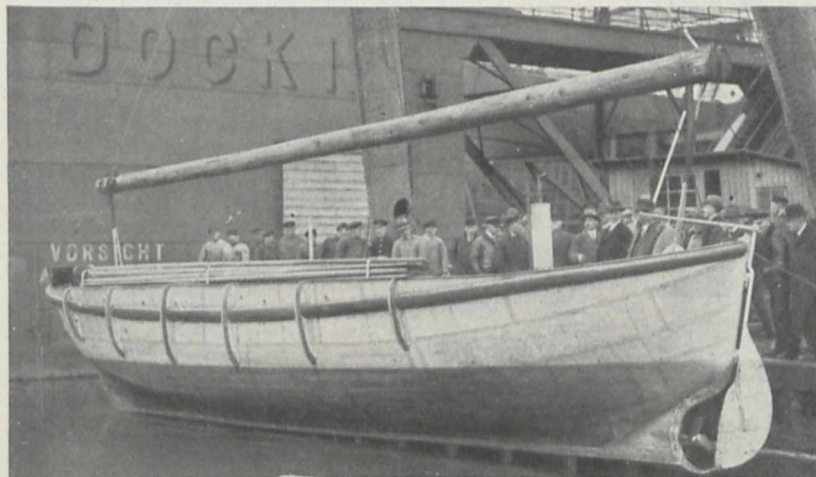
Fig. 1. Versuch zur Feststellung der Durchbiegung eines Rettungsbootes.
