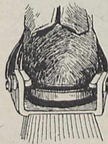
Fig. 2 (links). Der Sohlenhalter als Ersatz für den Zehenriemen bei der Thorleif-Haugh-Bindung.
