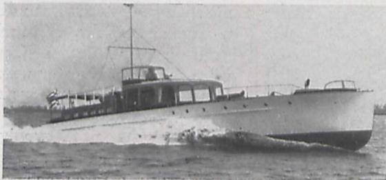
Fig. 1. Die amerikanische Luxusjacht „Oheka“, die mit 1350 PS eine Stundengeschwindigkeit von 60 km erreicht.
