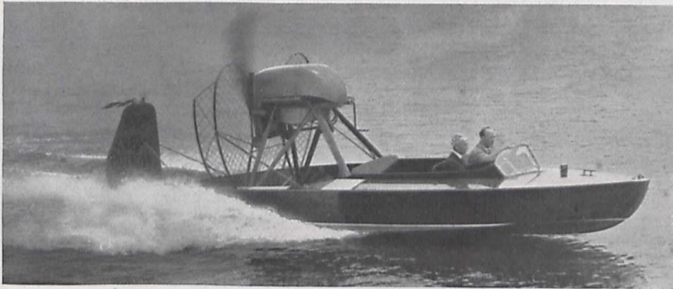
Fig. 4. Das amerikanische Motorboot „Whistler“ mit Luftpropeller-Antrieb.
