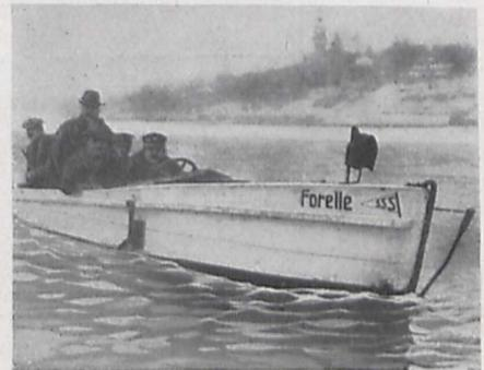
Fig. 5. Die „Forelle“ des Ing. Börner, die mit 6 PS ebenso schnell fährt, wie ein gleichgroßes normales Boot mit 50 PS.
