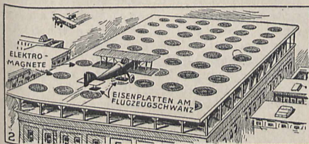
Fig. 1. Dachfläche mit eingebauten großen Elektromagneten als Flugzeug-Landeplatz.
