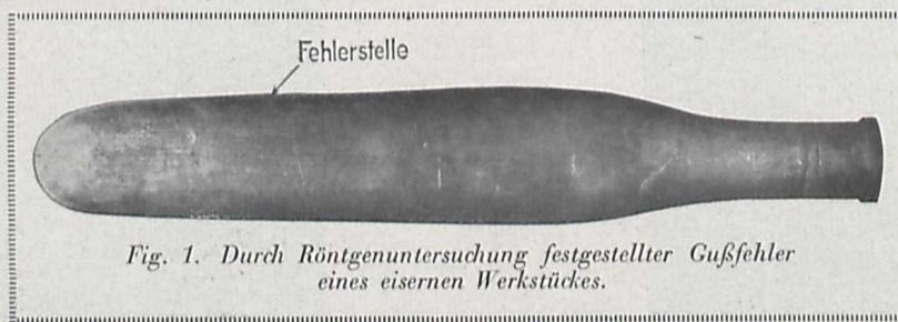
Fig. 1. Durch Röntgenuntersuchung festgestellter Gußfehler eines eisernen Werkstückes.
