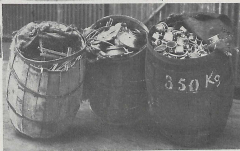
Fig. 5 (unten). Zu leicht verpackter Inhalt in Fässern nach dem Umladen in einem Hafen.
