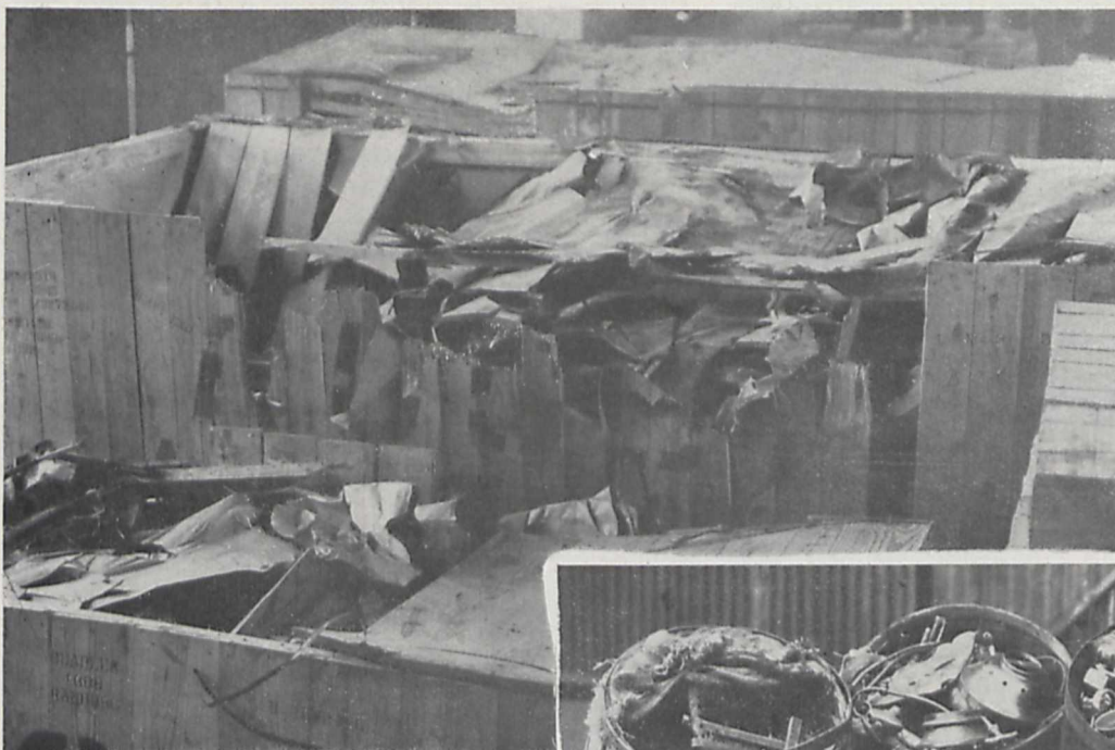
Fig. 4. Stark beschädigte Kiste, infolge ungenügender Versteifung und Sicherung durch Metallbänder.
