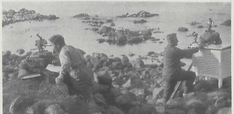
Fig. 3. Messung der Intensität der Sonnenstrahlung durch Aktinometer.
