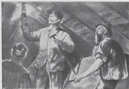
Fig. 6. Ableuchten von Schlagwettern mit der Benzin-Sicherheitslampe.
