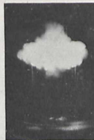
Explosion eines dünnen Drahtes bei plötzlichem Durchgang eines elektrischen Stromes von 40000 Volt.
