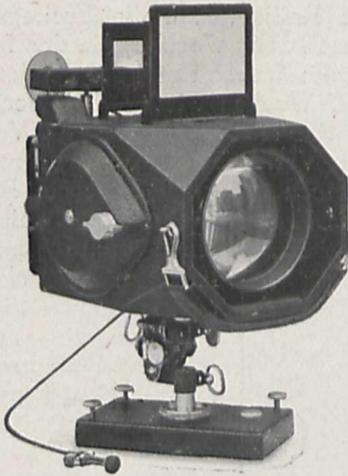
Fig. 1. Spezialkamera „Ermanox“ für Bühnenphotographie während der Vorstellung. (Lichtstärke 1:1,8). Zum Aufstellen auf der Logenbrüstung dient die bleibeschwerte Grundplatte mit Stellschrauben.
