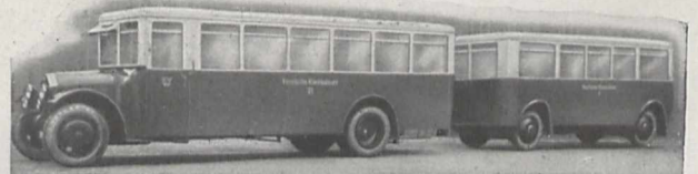
Fig. 4. „Niederomnibus“ mit Anhänger kann 85 Personen befördern.
