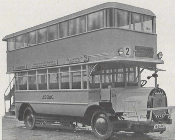
Fig. 2. Der neueste zweigeschossige Berliner Omnibustyp.
