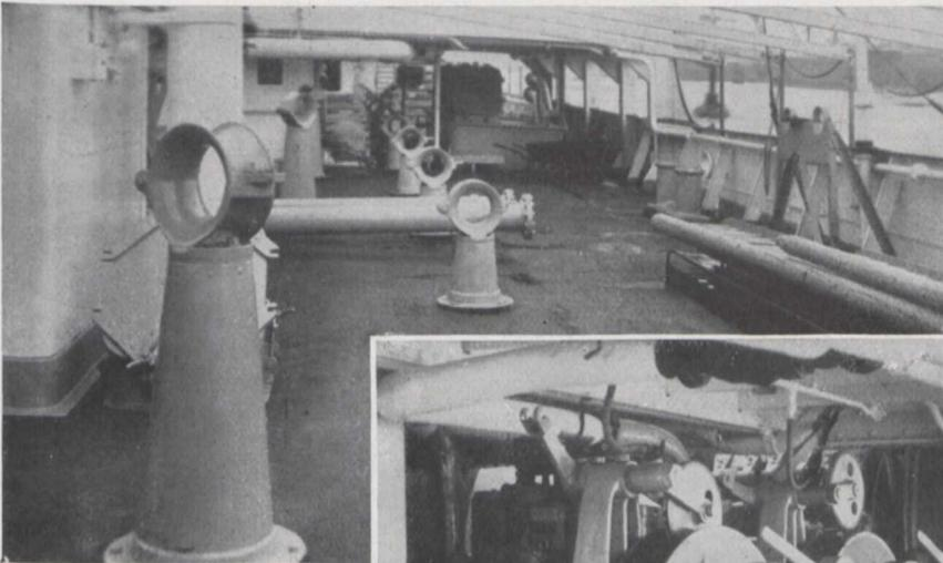
Fig. 2. Kabelbahn auf dem Hauptdeck.
