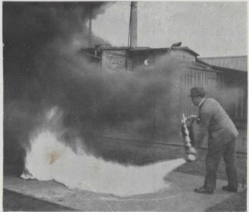
Fig. 3 (unten). Mit Benzin begossene, brennende Betonfläche wird mit dem Total-Handapparat gelöscht.
