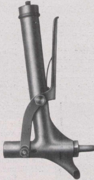
Fig. 4. Imprägnierhammer mit Impfnadel.
