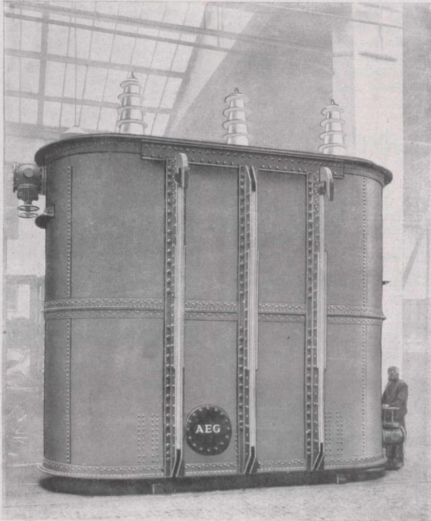
Fig. 1. Der Riesentransformator von 75 000 Kilvoltampere, den die AEG für das Goldenbergwerk des Rheinisch-Westfälischen Elektrizitätswerkes lieferte. Seine PS-Leistung entspricht der von 80 Schnellzugslokomotiven.
