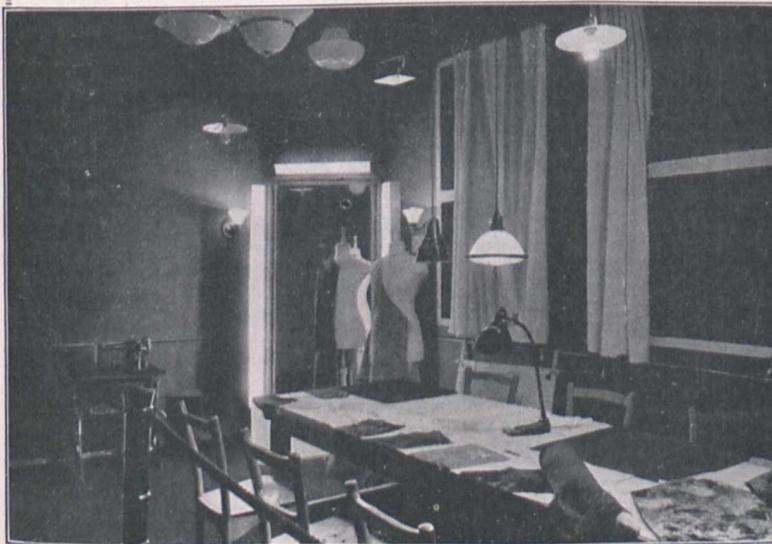
*Fig. 4. Ein Ausstellungsraum der Gesolei, in dem die günstigste Beleuchtung für Arbeitsräume und für einzelne Arbeitsplätze gezeigt wird. Die Räume sind von Prof. Dr. Teichmüller, dem Direktor des Lichttechnischen Instituts der Technischen Hochschule Karlsruhe i. B., eingerichtet.*
