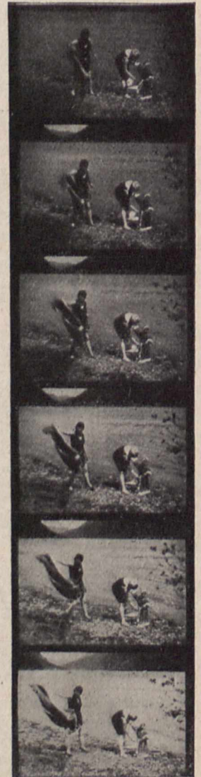
Fig. 5. Probekopiebelichtungsstreifen zur Feststellung der erforderlichen Stärke des Kopierlichtes.
