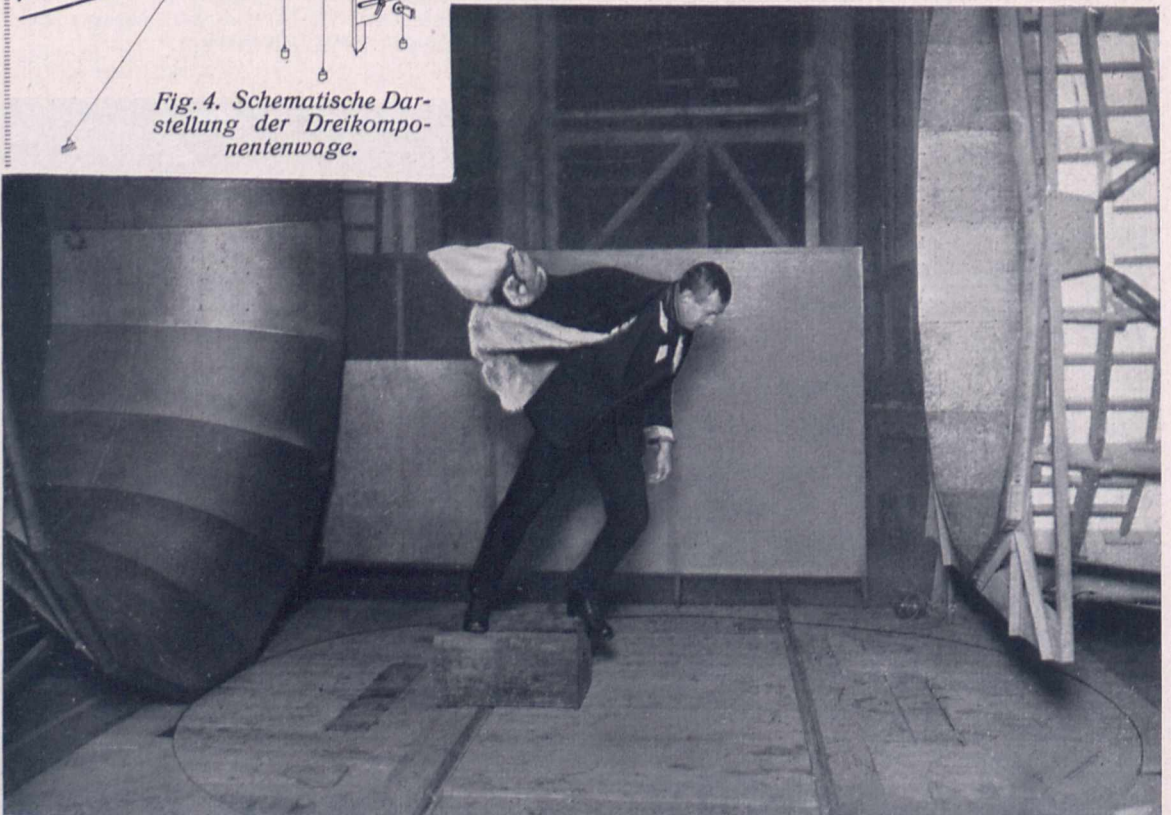
Fig. 6. Der Versuchsstand des großen Windkanals nach Fortnahme der Dreikomponentenwaage. Man sieht, wie der Mann gegen den heftigen Wind ankämpft. Oben links: An der Dreikomponentenwaage hängt das Modell eines Wasserflugzeuges.
