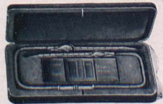
2 Mischpipetten (an der Peripherie des Kästchens) und Zählkammer (in der Mitte) zur Blutkörperchenzählung.
