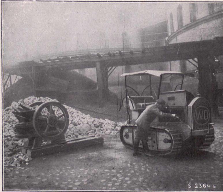
Fig. 5. Raupenschlepper als Antriebsmotor eines Steinbrechers.
