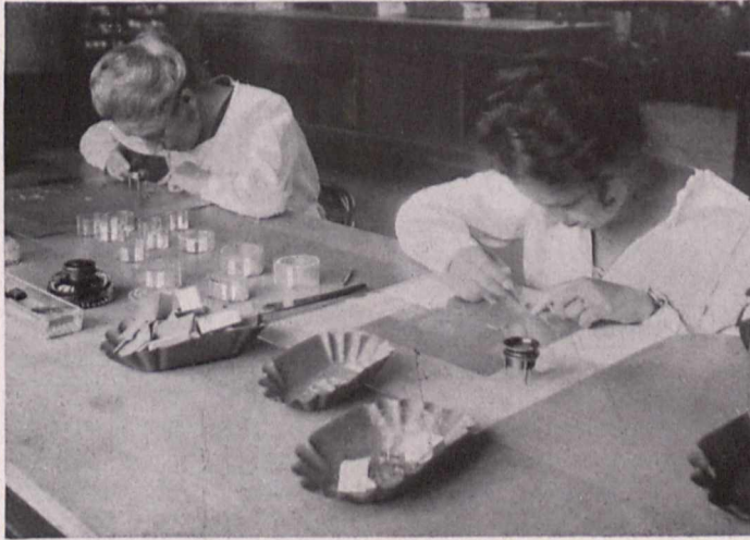
Fig. 2. Im Hauptarbeitssaal einer Samen-Kontrollstation. Eine bestimmte, auf einer Milligrammwage abgewogene Saatmenge wird in ihre einzelnen Bestandteile (Reinheit, fremde Kultursamen, Unkrautsamen, Bruch, Spreu und Sand) zerlegt.
