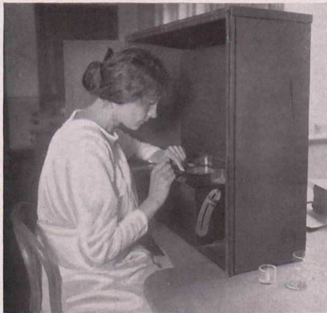
Fig. 3. Reinheitsbestimmung von Grassämereien am Samenspiegel (Diaphanoskop).
