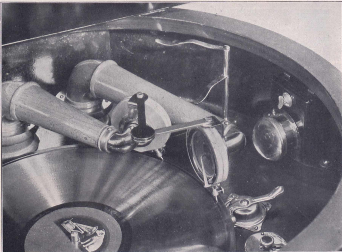
Die beiden Tonarme und Schalldosen des Ultraphons mit der Einrückvorrichtung und der elektr. Beleuchtung.
