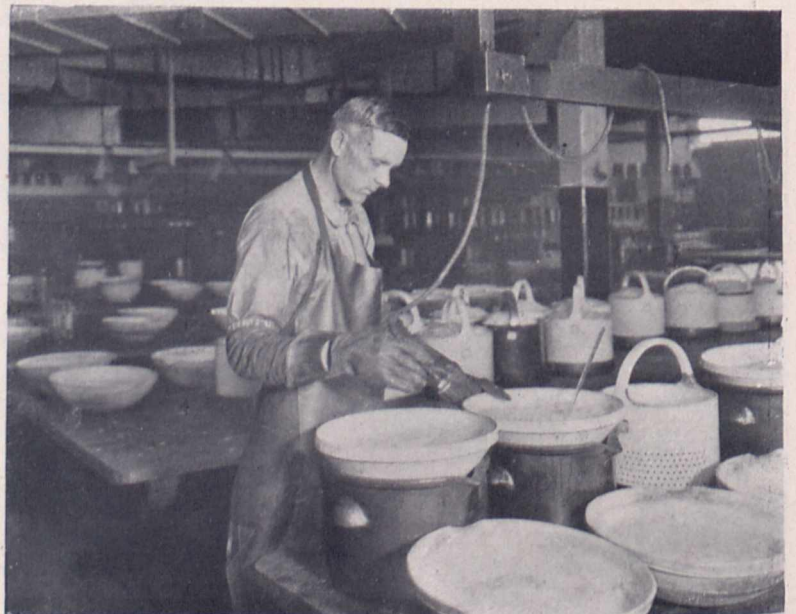
Fig. 7. Herstellung des Silbernitrats für die lichtempfindliche Emulsion.
