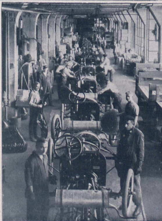
Fig. 5 (Mitte). Schlußmontage-Band des Fordwagens, an dessen Ende das fertige Auto mit eigener Kraft davonfährt
