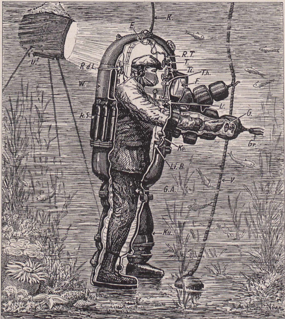
Fig. 3. Wie die Taucherrüstung innen aussieht.
