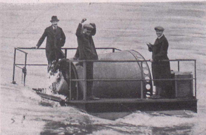
Fig. 1. Freistromturbine von Ingenieur E. Suess. Das Gehäuse mit dem Laufrad ist zwischen den Schwimmkörpern aus dem Wasser hochgezogen.
