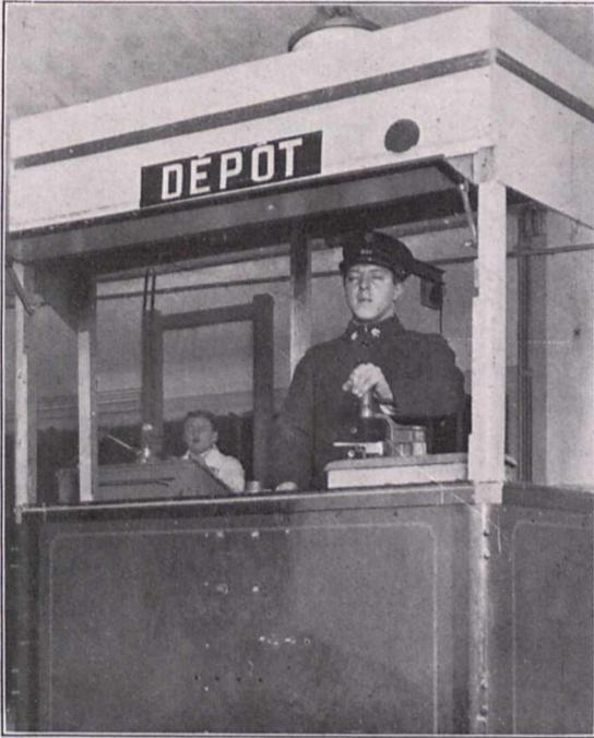
*Fig. 1. Prüfstand für Straßenbahnführer.* Der Prüfling hat auf bestimmte, vorher verabredete Filmbilder und Signallichter zu reagieren, wobei er durch Geräusche und Lichter gestört wird. Die Leistungen werden von einem Beobachter mittels bekannter Instrumente registriert.
