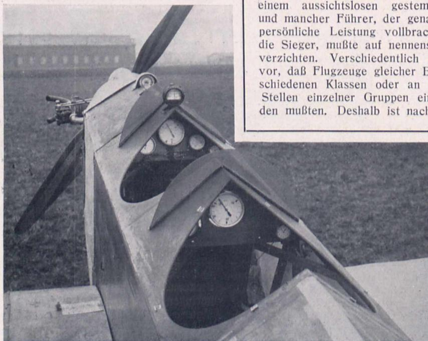
Fig. 2. Mercedes-Daimler-Leichtflugzeug L 20. Sitzanlage.
