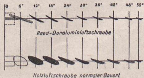
Fig. 5. Profile der Reed-Duraluminluftschaube und Holzluftschaube normaler Bauart.
