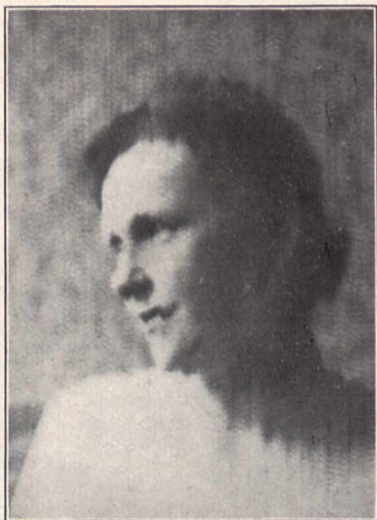
Fig. 5. Mit dem ersten Versuchsapparat eines ‚Phototelaugraphen‘ übertragene Photographie.
