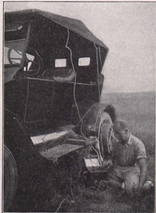
Fig. 4. Der „Ford“ als Antrieb für den Generator. (Sender).
