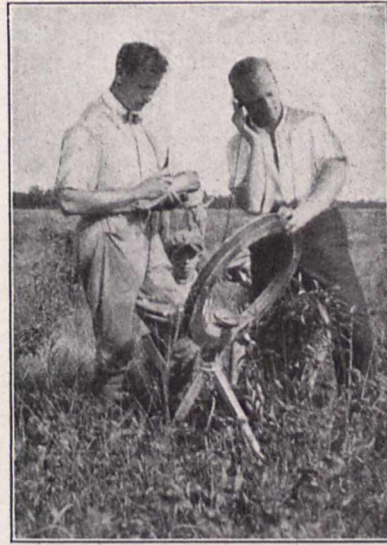
Fig. 3. Aufnahme der Stromlinien mit Empfangsgerät und Telefon.
