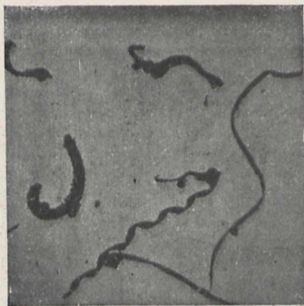
Fig. 1. Erloschene Funken von Nickeleisen, der Glasplatte lose anhaftend. (nach Bermann)
