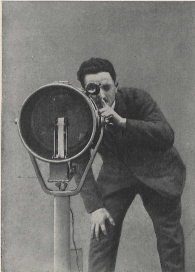
*Fig. 1. Charbonneau's Apparat zum Empfang von Morsezeichen durch das Auge vermittelt infraroter Strahlen.*
