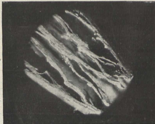
Fig. 4. Hartes Aluminiumblech nach 207 tägigem Aufenthalt im Wasser. (16fach vergr.)
